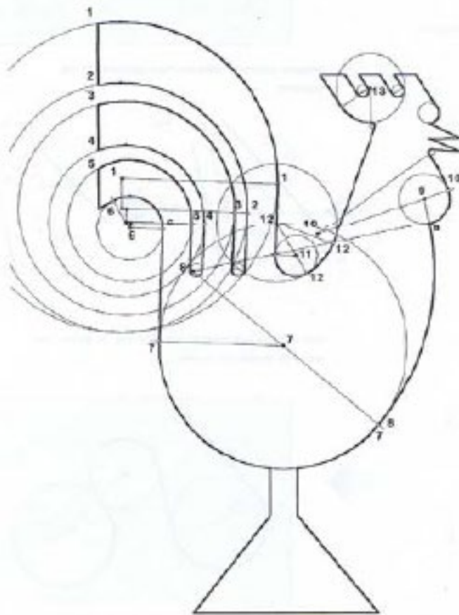
Costruzione geometrica della figura con definizione dell'esatta posizione dei centri delle circonferenze e dei punti di tangenza e raccordo.
