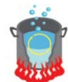
figura 7.15 Il trasferimento di calore nei liquidi avviene per convezione, cioè per spostamento di massa. Il liquido riscaldato si dilata, diminuisce di densità e sale verso l'alto, sostituito dal liquido più freddo, che scende.
